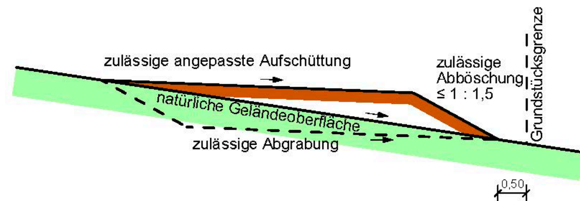
Abb. 6: Beispiel zulässige Aufschüttung/Abgrabung und Böschungswinkel.
